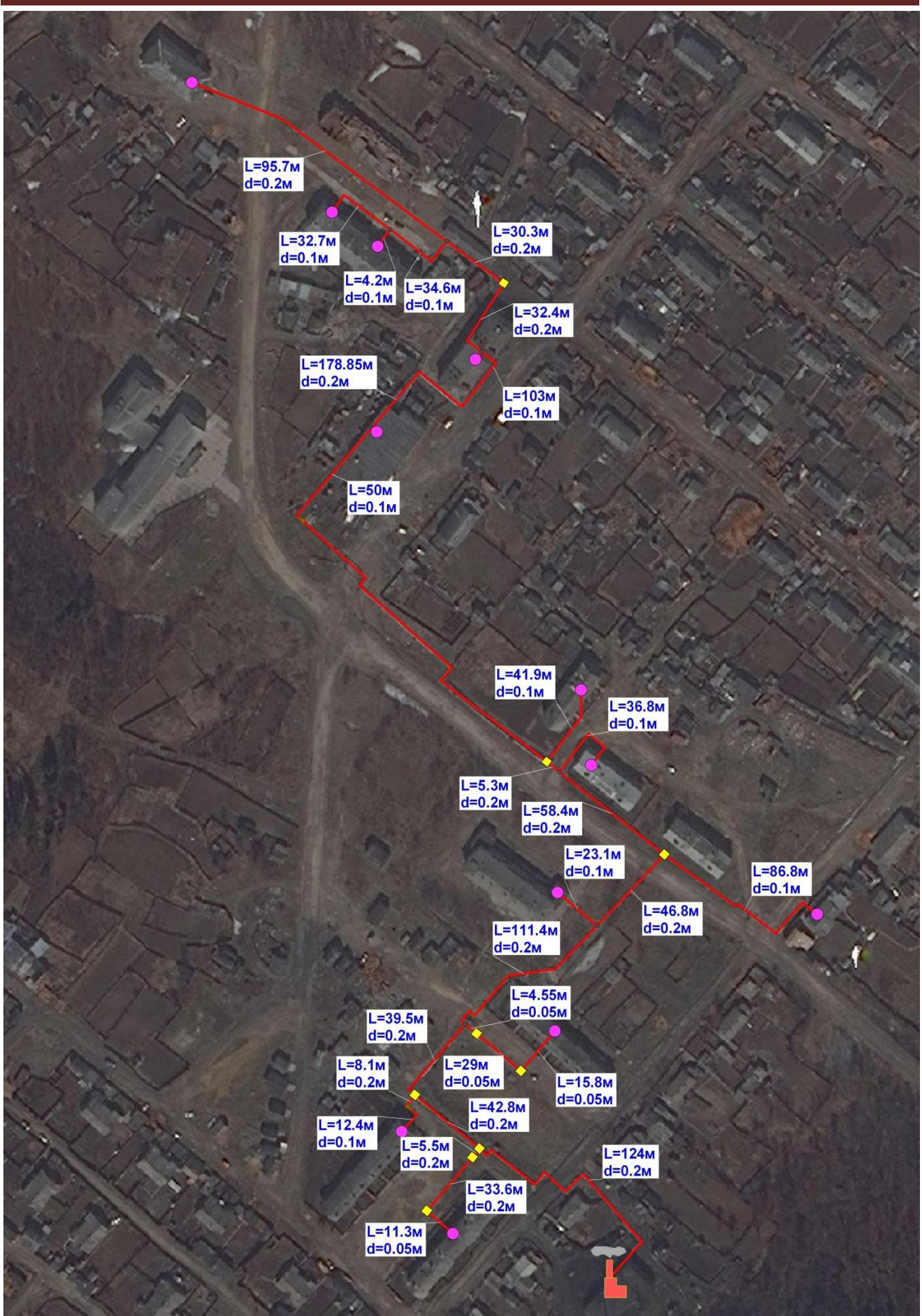
Рис.2.2 – Схема теплоснабжения села Константиновка
