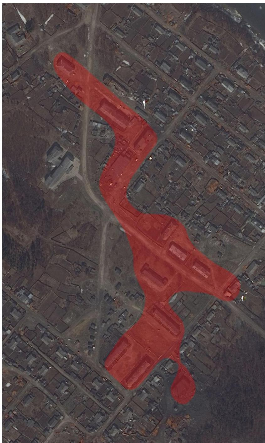
Рис.9.1 – Зона действия котельной №1
